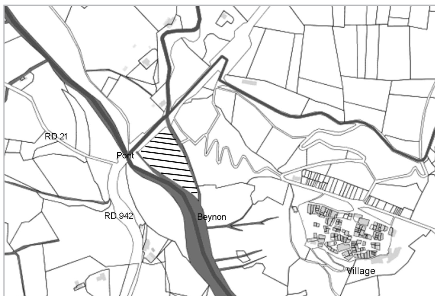
Zone hachurée : endroit potentiel pour l'installation d'une nouvelle station d'épuration
