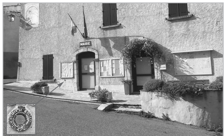
Repère de nivellement au bas de la façade de la mairie : 676 m d'altitude
